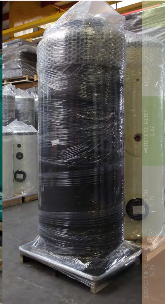
1500 l 3 bar Ø 1000 mm Anschlussmuffen 2" Anschlüsse im 90°-Winkel Einlaufbögen DN 50 Prallbleche Hissösen
