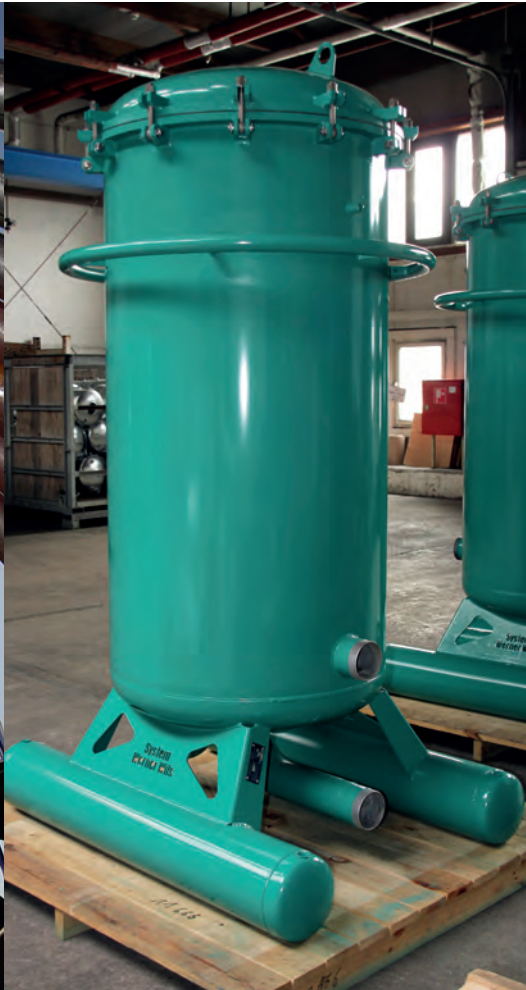
1430 l 3 bar Ø 900 mm Anschlussmuffen in 2" Anschlüsse im 90°-Winkel Schichtleitkanäle Revisionsflansch DN 200 Vorschweißflansch mit Rohrbogen DN 25 / DN 125
